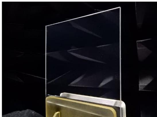
Transparente transmissive Meta-Oberfläche (Prototyp)
